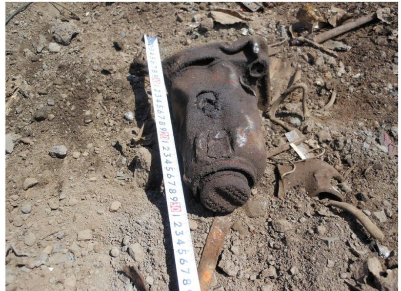
タンク類、油圧ジャッキ類等の密閉物は製鋼電気炉内で爆発の危険があります。適正な処理がされていないものは返却させていただきます。電気炉内で密閉物による爆発が起こった場合には、電気炉設備損傷の可能性のほか、爆風や溶鋼の飛散により作業員への**重大人身事故**に繋がる恐れがあります。
