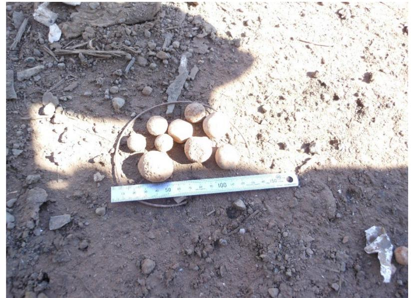
ボールミルの粉碎用ボールやベアリングの部品として回転部分に使用されています。サイズが小さい為発見が難しく、Cr含有率が高いのが特徴です。高Crとなった溶鋼は製品J I Sに規定された強度を越えるため、**全量廃却**となります。
