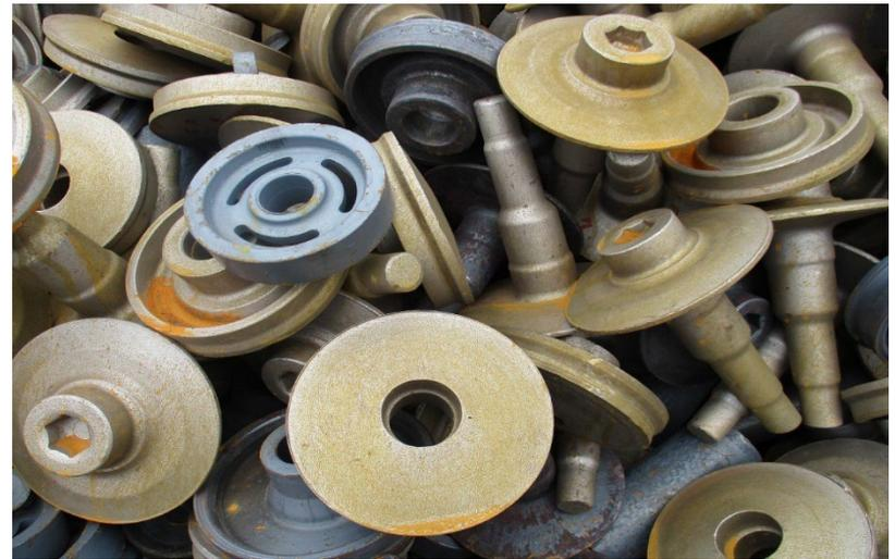
車の変速機部品に使われており、耐摩耗性・耐振動性等の部品強度を向上させる為にCr、Ni、Moを多く含んでいるのが特徴です。
