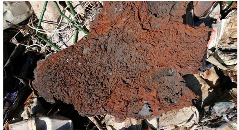
熱影響により金属が溶けた後、冷えて塊状になった金属です。
